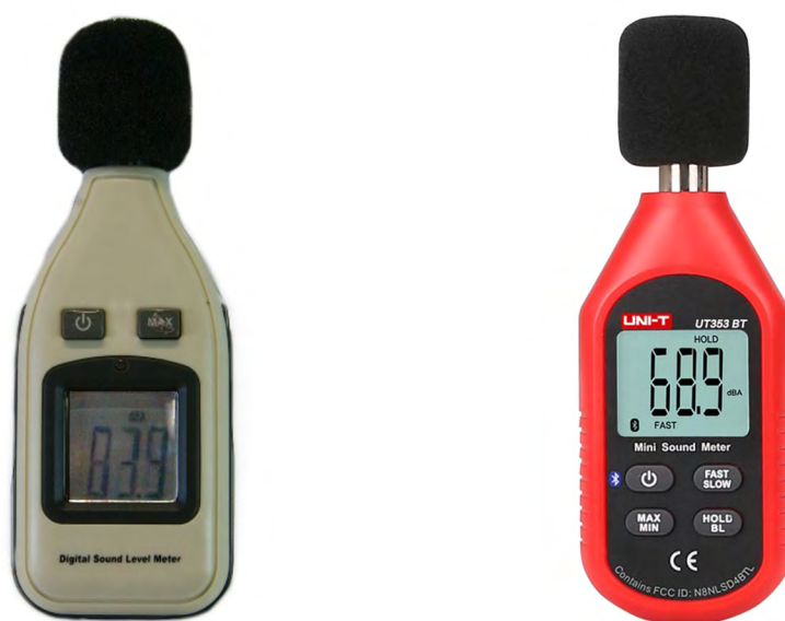
Рис. 1. Приборы для измерения акустического воздействия (шумомер)
