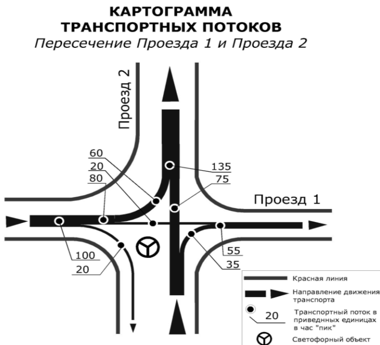
Рис. 1. Пример оформления картограммы транспортных потоков
