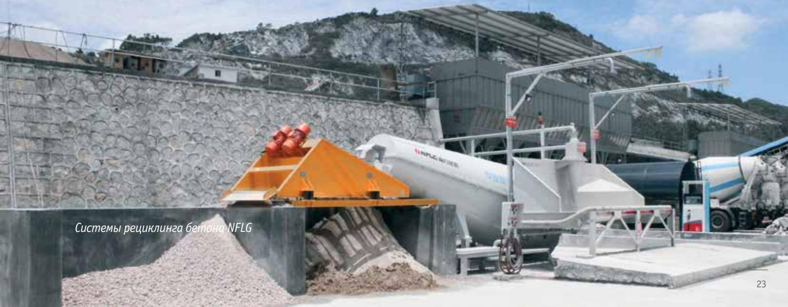
Системы рециклинга бетона NFLG
