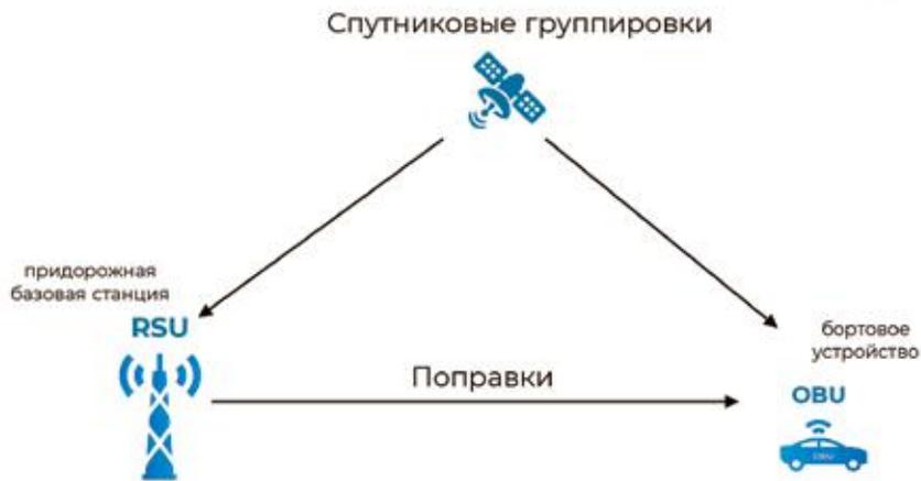
Точность позиционирования беспилотных автомобилей
