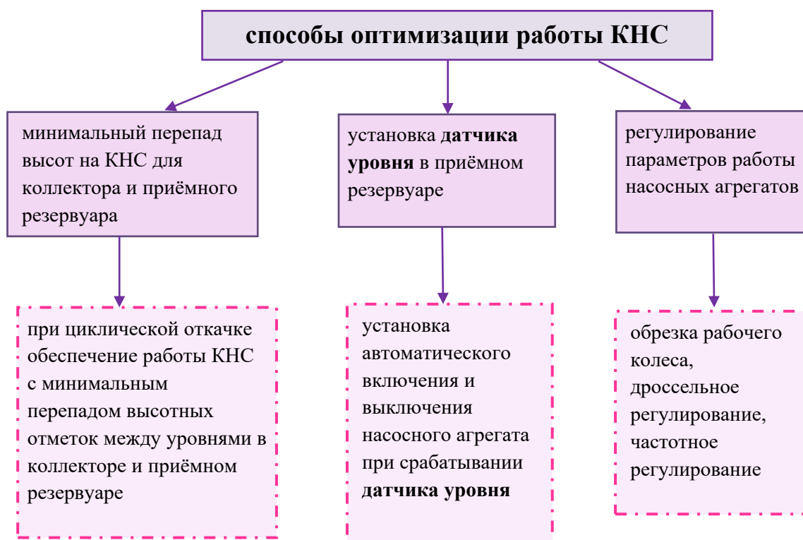
Рис. 2. Мероприятия по оптимизации функционирования действующей КНС
