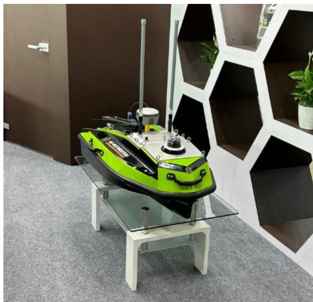
Рис. 2. Беспилотный водный эхолот «РосСтройКонтроль» на выставке «100+ TechnoBuild» [6-8]
