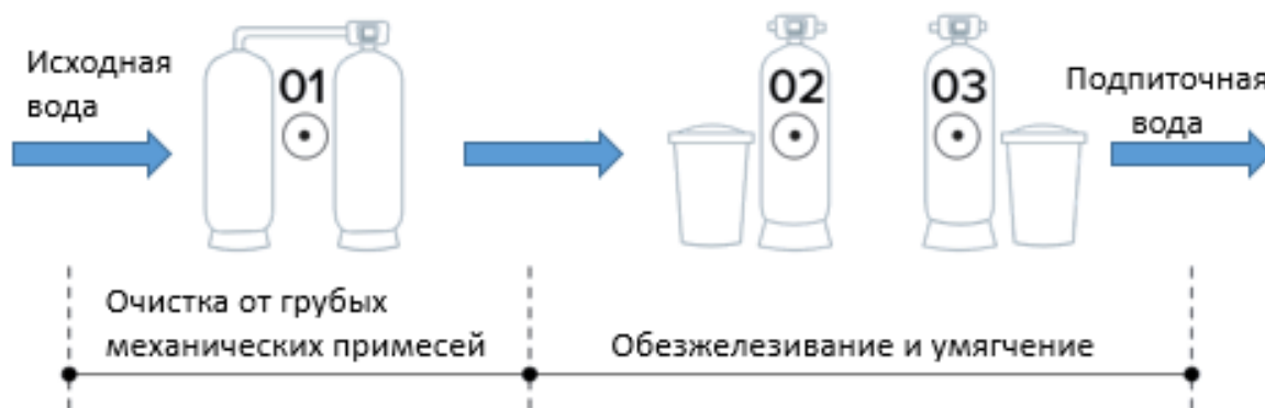
Рис. 1. Типовая схема подготовки воды для горячего водоснабжения
