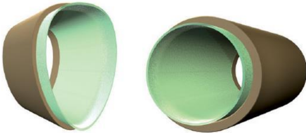
Рис. 3. Образцы фрагментов восстановленных трубопроводов
