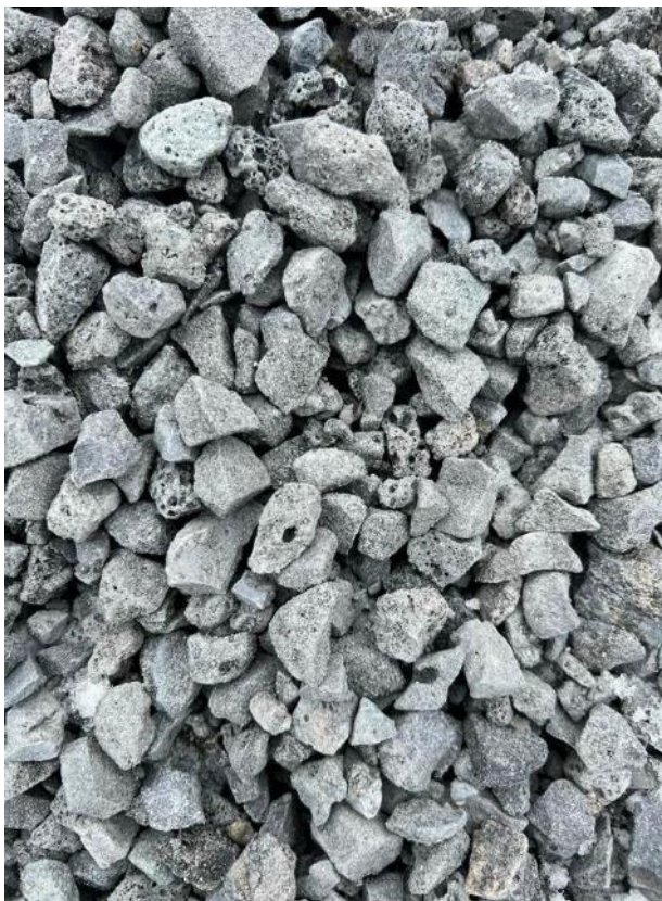
Рис. 1. Внешний вид щебня из отвального металлургического шлака
