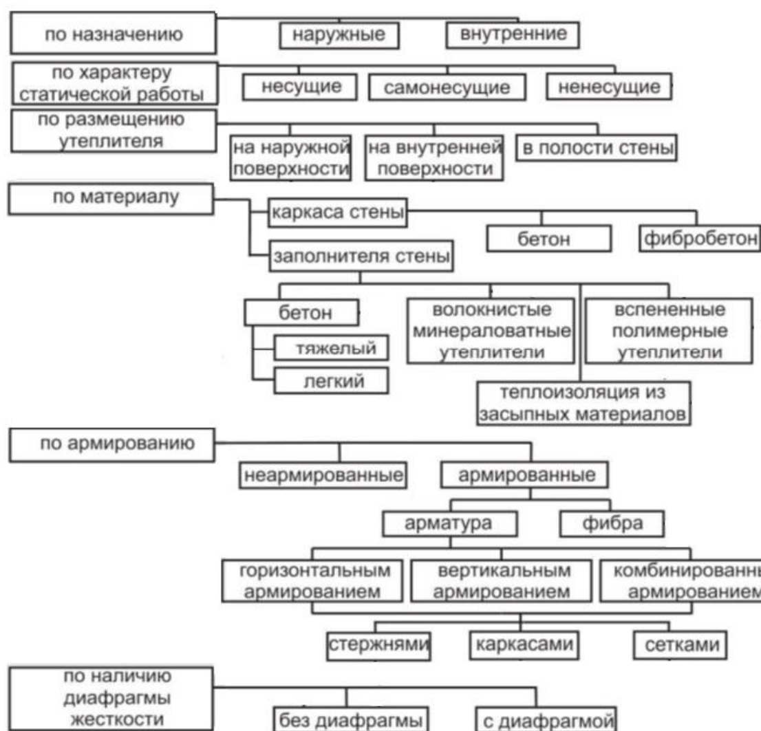
Рис. 1. Классификация 3D-печатных стеновых изделий [3].
