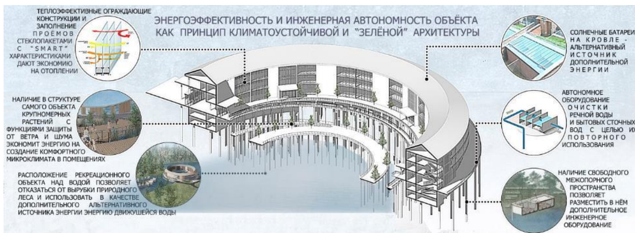
Рис. 4. Применение автономных систем жизнеобеспечения на примере концептуального студенческого проекта рекреационного объекта (тур. базы) в зоне возможного паводкового разлива рек (автор – студентка МГСУ Паламарчук Д.)
