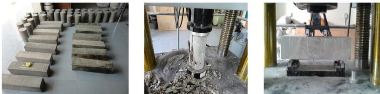
Рис. 2. Испытания образцов бетона на сжатие и растяжение на изгиб
