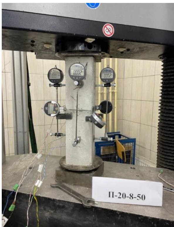
Рис. 2. Образец 100x100x400 мм перед испытанием.
