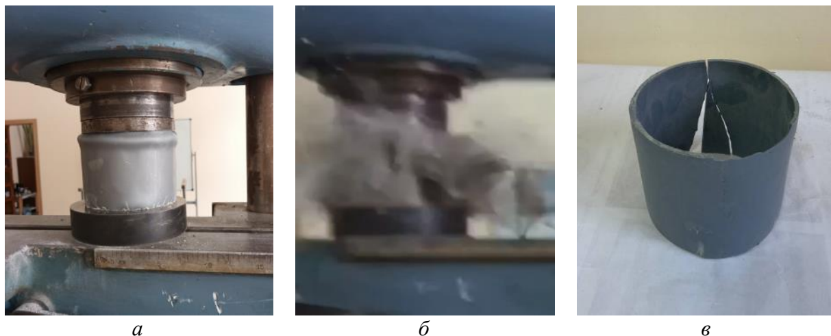
Рис. 4. Характер разрушения трубобетонного стержня по нормальному сечению: а – образец из трубы РР-Н 110х2.7 длиной 100 мм; б – момент взрыва образца за счет разрыва оболочки; в – полимерная труба после разрушения трубобетонного образца
