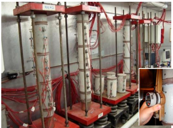
Рис. 11 – Схема загрузочной рамы для проведения испытаний по определению деформаций ползучести бетонных образцов и процесс испытаний
