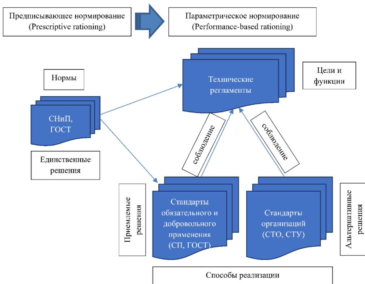
Рис.2. Отличия параметрического нормирования от предписывающего
