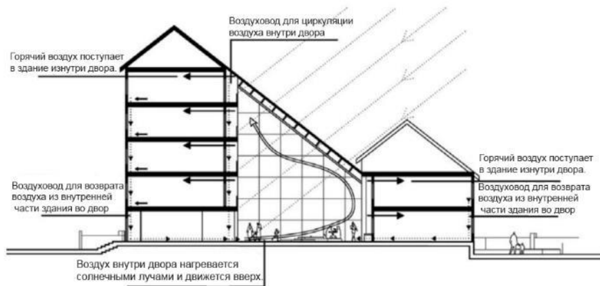
Рис.7. Зимнее использование центрального двора и то, как внутри него циркулирует воздух
