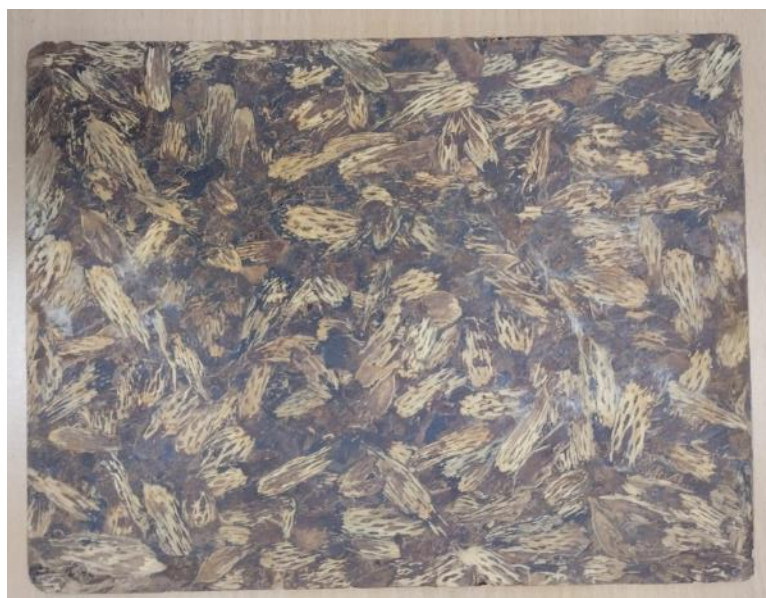
Рис. 2. Декоративные плитные материалы из отходов производства кедрового ореха размером 200×200×5 мм
