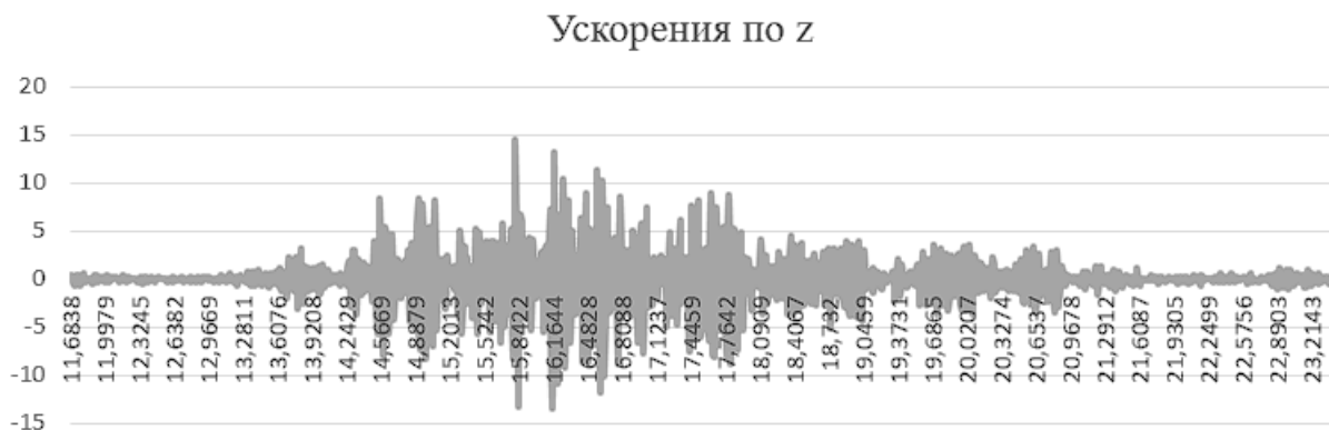
Рис. 4 – Акселерограмма при имитации режима повышенной нагрузки.
