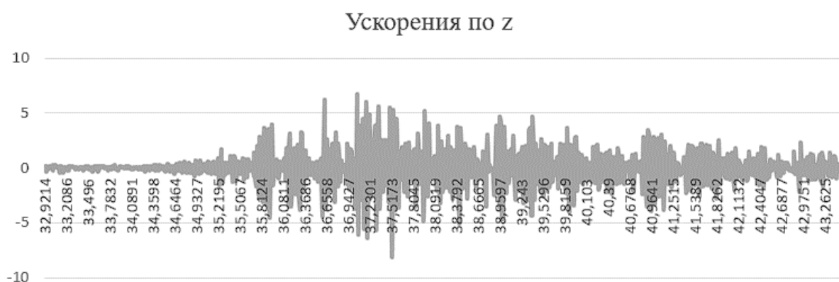
Рис. 3 – Акселерограмма при имитации эксплуатационного режима движения.
