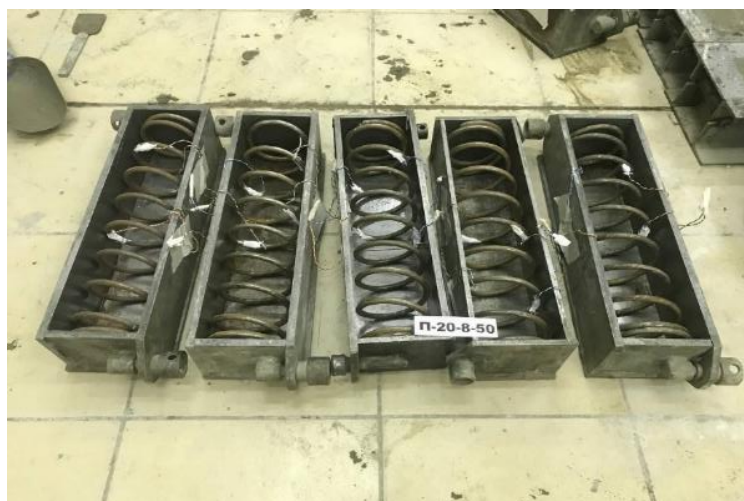
Рис. 1. Серия образцов 100x100x400 мм со спиральным армированием перед бетонированием.
