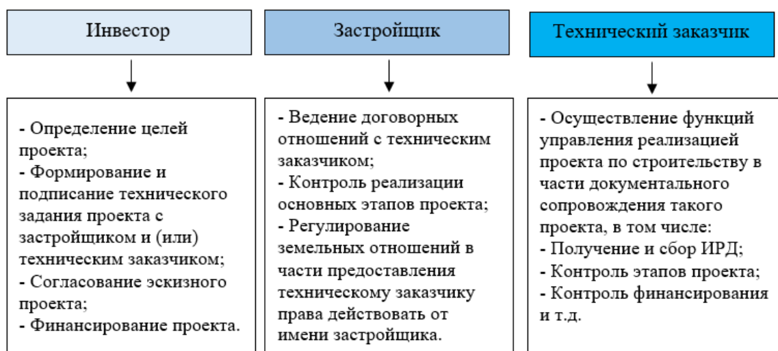
Рис. 1 – Основные функции инвестора, застройщика и технического заказчика при реализации проекта по строительству
