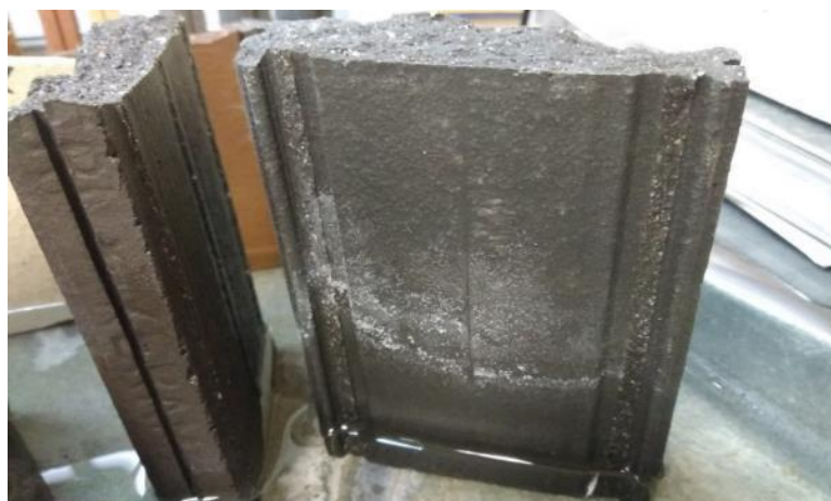
Рис. 6. Разломанный образец кирпича после определения водопоглощения
