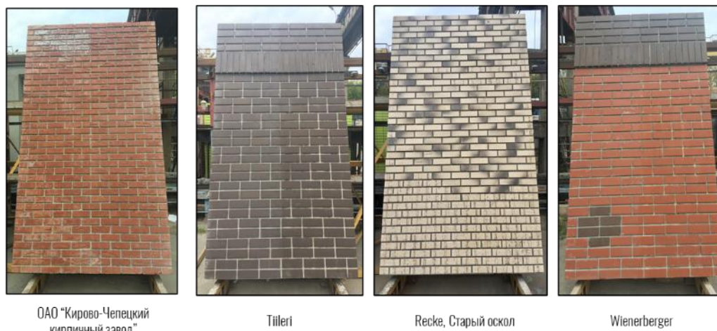
Рис. 7. Обработка правой части панелей смывками и гидрофобизаторами.
