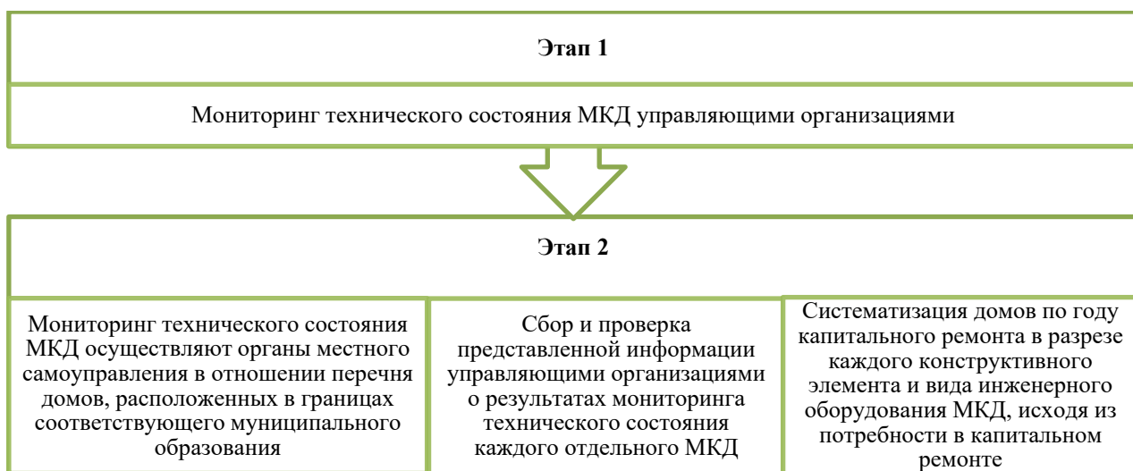
Рис.3. Этапы мониторинга технического состояния МКД (составлен авторами)
