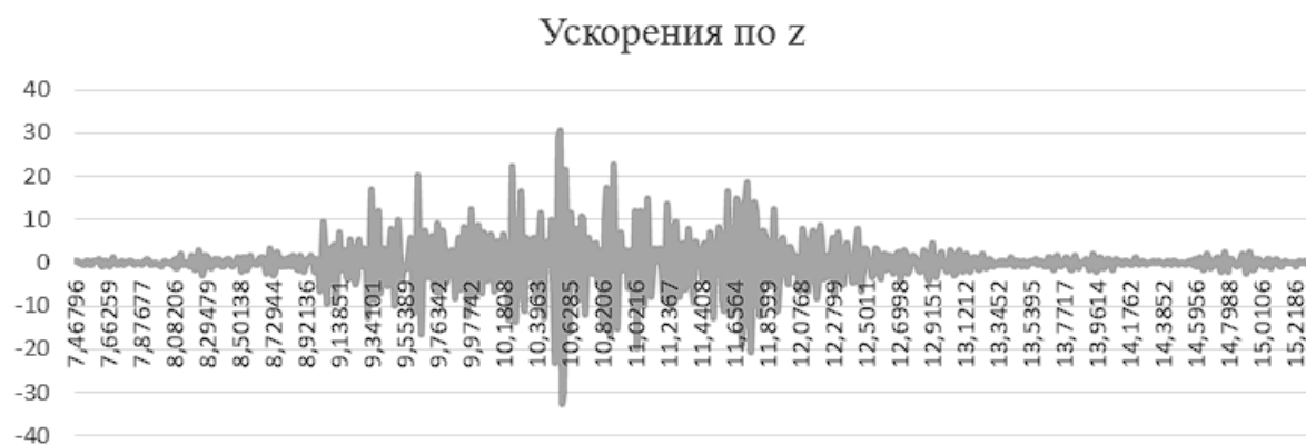
Рис. 5 – Акселерограмма при имитации эвакуационного режима движения.
