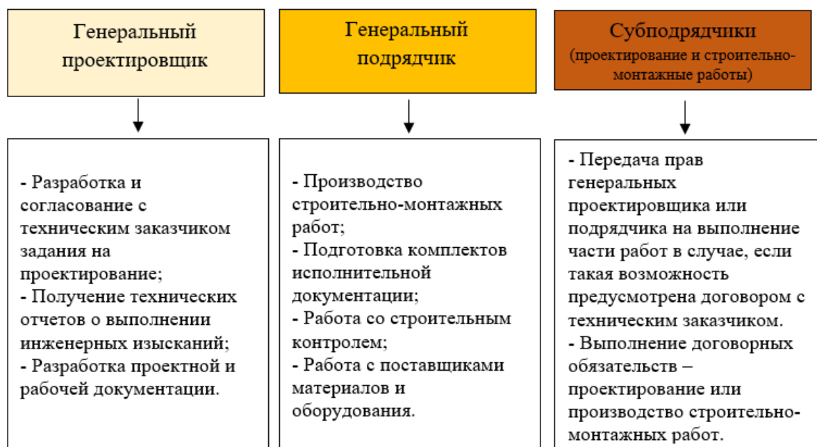
Рис. 2 – Основные функции генерального проектировщика, генерального подрядчика и субподрядчиков при реализации проекта по строительству
