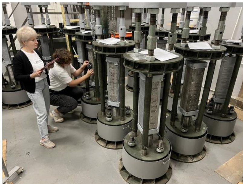
Рис. 12 – Используемое оборудование при проведении испытаний по определению деформаций усадки и ползучести
