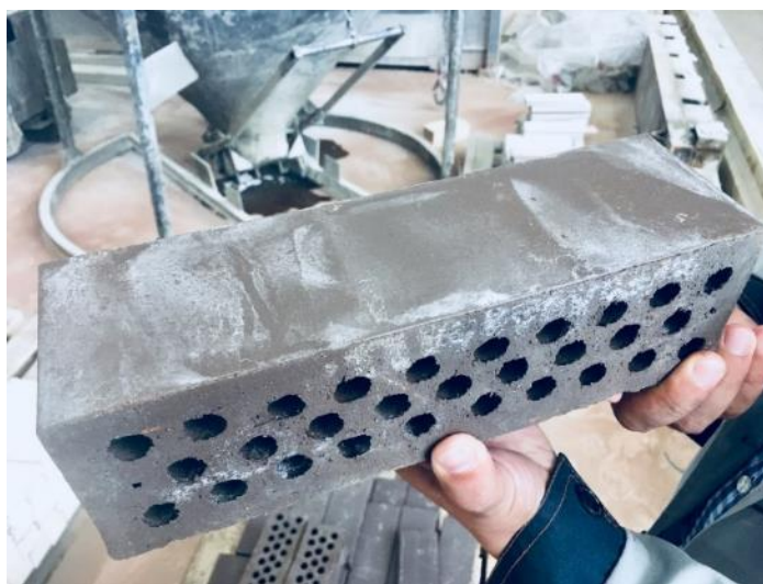
Рис. 5. Образование высолов на поверхности кирпича без цементной системы.
