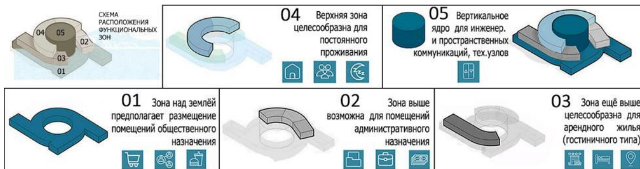
Рис. 3. Приоритетность расположения функциональных зон архитектурных объектов с точки зрения безопасности в условиях наводнений
