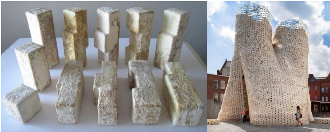
Рис. 4. Башня из грибных кирпичей.
