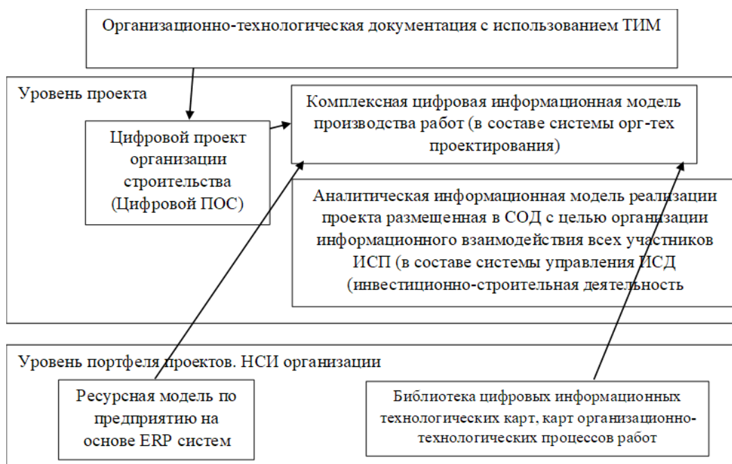
Рис. 2. Схема организационно технологической документации с использованием ТИМ
