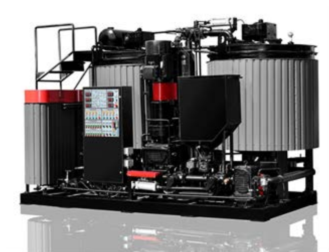
Рис.6. УВБ-2, установка для модификации битума
