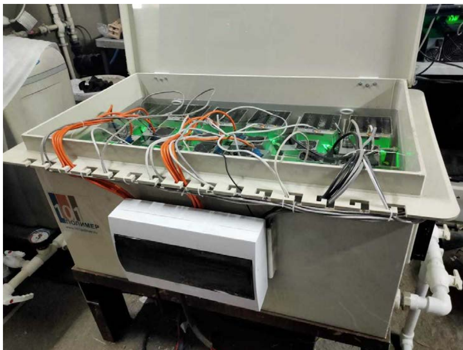
Рис. 2. Ванна для майнинг-фермы с иммерсионной жидкостью
