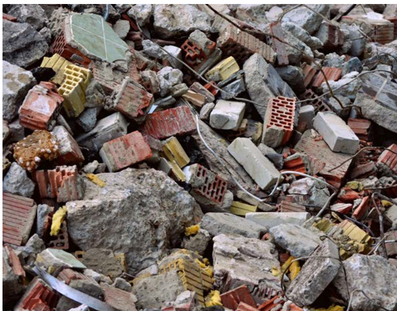
Рис. 1. Отходы строительства и сноса зданий и сооружений
