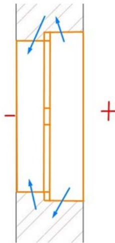
Рис. 7. Узел примыкания оконного блока к стене
