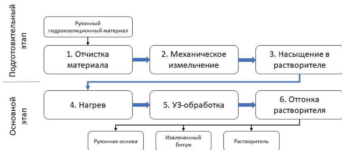
Рис. 1. Технологическая схема получения рекуперационных битумов
