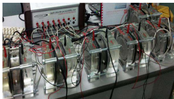
Рис. 2. Проведения испытаний для определения проницаемости структуры бетонов для ионов хлора
