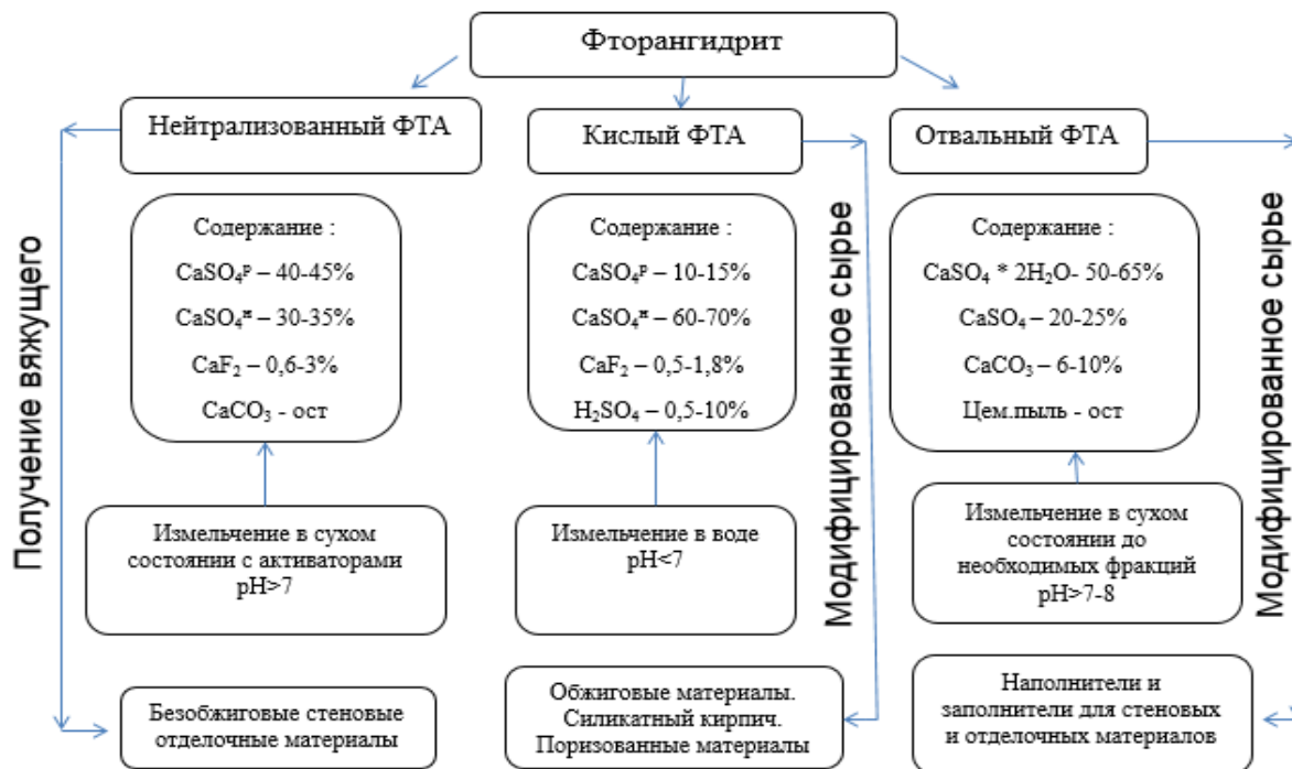
Рис. 1. Классификация фторангидрита по вещественному составу и применению
