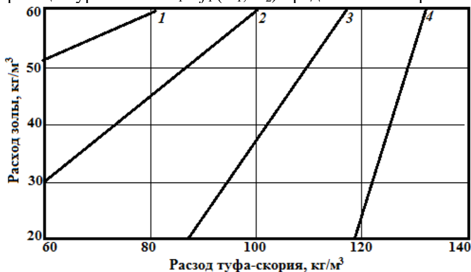
Рис. 3. Зависимость прочности комплексного вяжущего от расходов туфа-скория и золы кофейной шелухи. Прочность при сжатии, МПа: 1 – 120; 2 – 100; 3 – 80; 4 – 60
