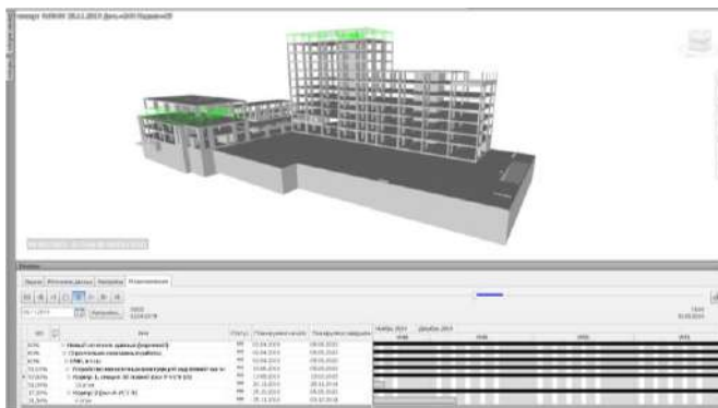
Рис. 2. Пример создания 4D-модели
