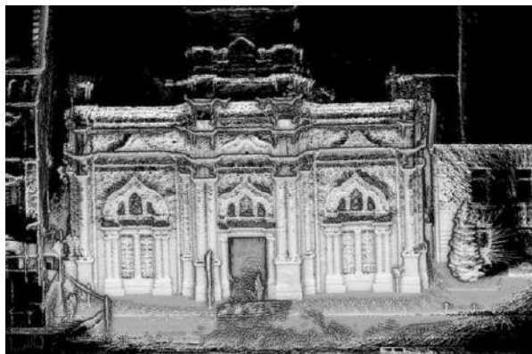
Рис. 2. Результат съемки сканером GEOSLAM ZEB1
