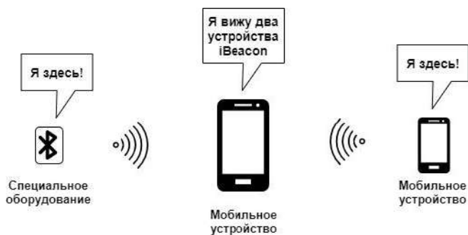
Рис.2. Принцип работы iBeacon.
