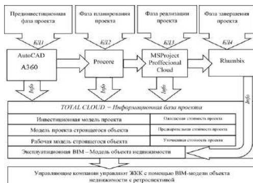
Рис. 1 Модель строительного проекта на основе облачных технологий [5]
