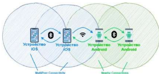
Рис.2. Схема предпочтительного соединения технологий Multipeer Connectivity и Nearby Connections.
