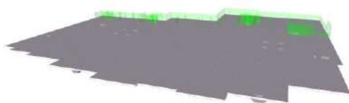
Рис. 3. Визуализация многоуровневого графика производства на 1-2 недели в Autodesk Navisworks. Timeliner.
