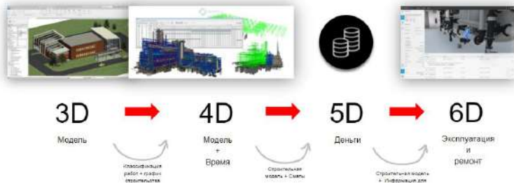
Рис. 1. Этапы создания модели от 3D до 6D модели
