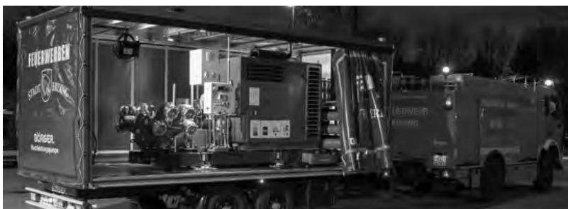
Рис. 3. Мобильные противопожарные системы – передвижные насосы.
