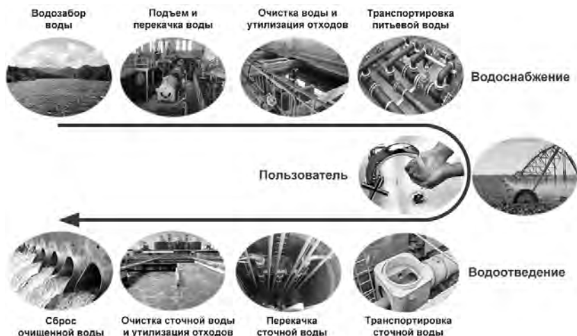
Рис. 2. Схема производства и предоставления водоканалом услуги пользователю-абоненту
