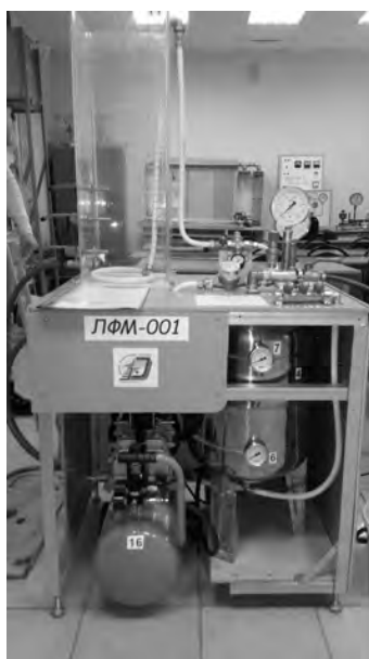
Рис. 1. Общий вид лабораторной флотационной установки ЛФМ-001: 1, 5, 10, 12, 22 – кран шаровый запорный; 2 – счетчик крыльчатый СВУ-15; 3, 8, 19 – клапан запорный; 4 – камера аэрации; 6, 7 – термометры; 9 – регулятор давления (редуктор); 11 – камера флотации; 13, 14, 15 – пробоотборник; 16 – компрессор; 16.1 – манометр; 16.2 – регулятор давления; 17, 21 – манометр; 18 – клапан обратный; 20 – клапан предохранительный; 23 – рассеиватель
