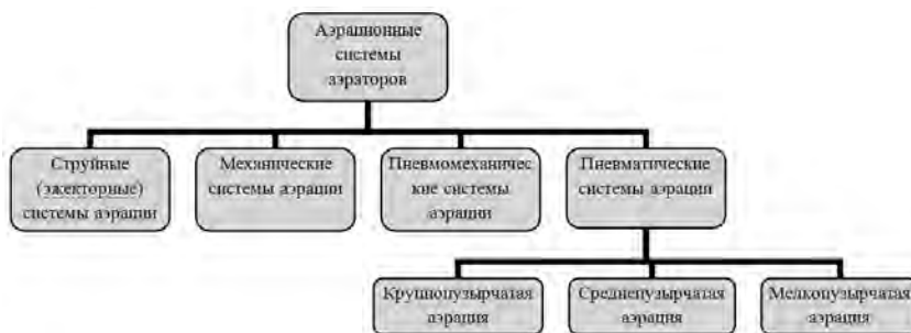
Рис. 3. Классификация аэрационных систем аэротенков [6]
