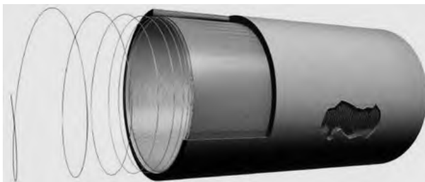
Рис. 2. Вид восстанавливаемого участка трубы по технологии StrongPIPE® Hybrid FRP
