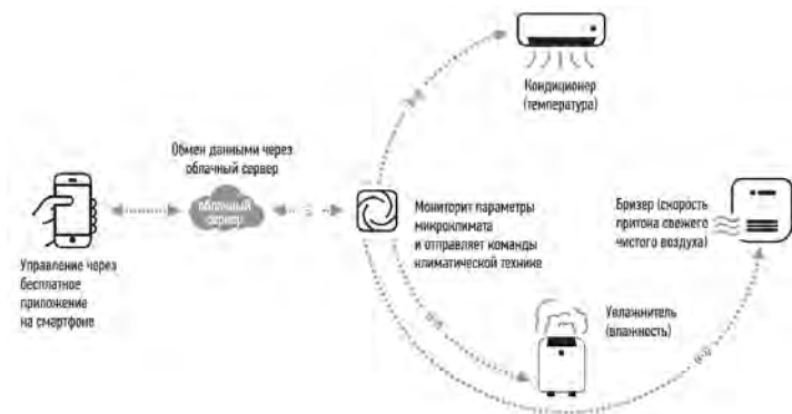
Рис. 1. Схема дистанционного управления СОМ. Управление и мониторинг будет осуществляться через сеть Интернет
