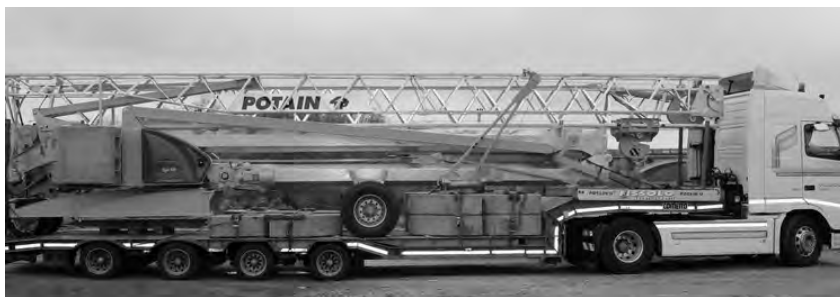
Рис. 3. Перевозка быстромонтируемого башенного крана
