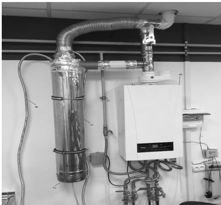
Рис. 1. Опытная установка конденсационного экономайзера:
