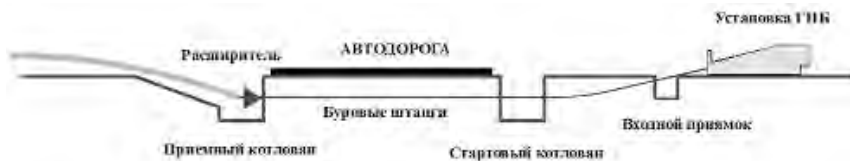
Рис. 4. Схема производства горизонтально – направленного бурения
