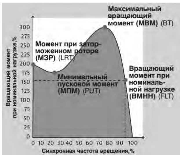
Рис. 4. Зависимость вращающего момента от частоты вращения
