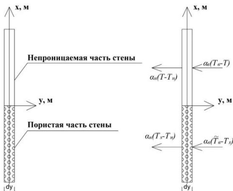
Рис. 1. Расчётная схема для составления математической модели
