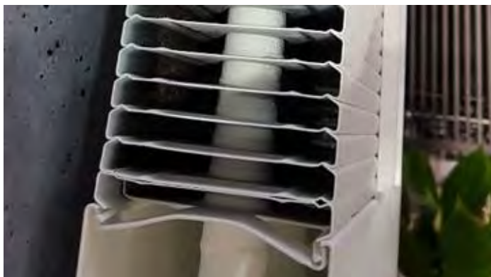
Рис. 4. Место контакта пластины ребрения
