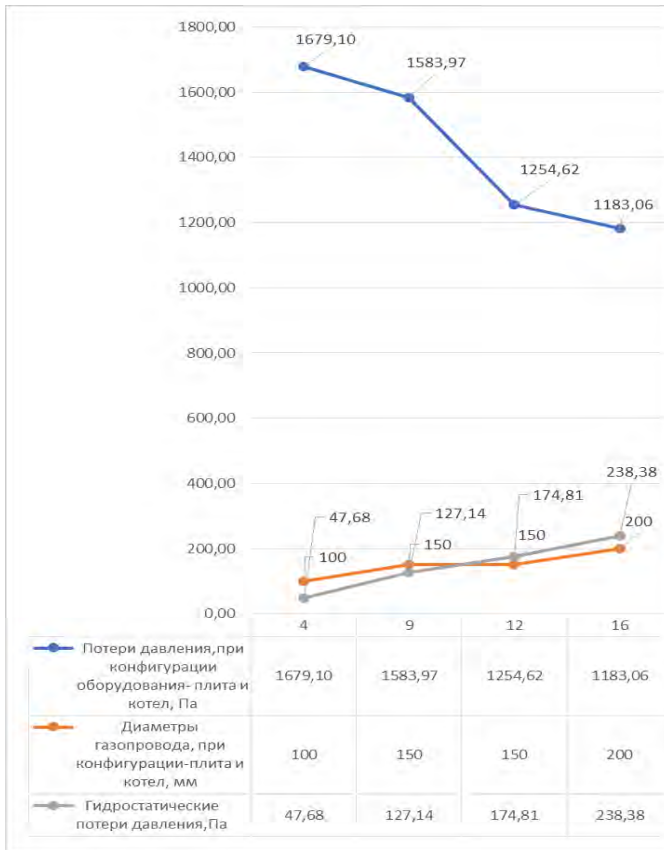
Рис. 1. Результаты расчета внутридомового газопровода
