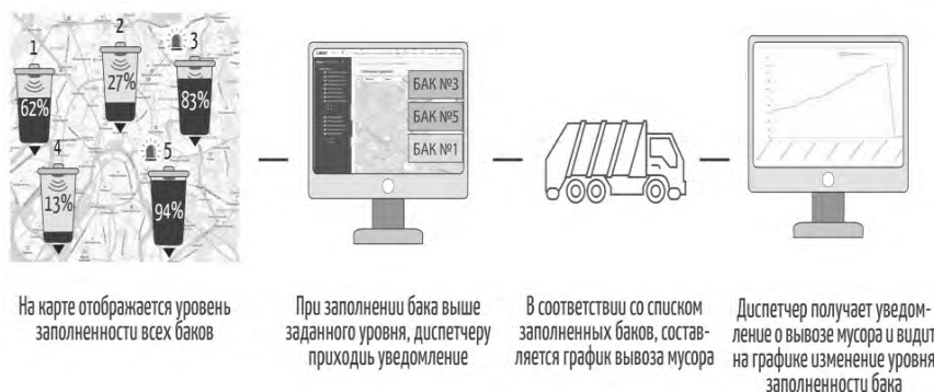
Рис. 4. Принцип работы датчиков наполнения
