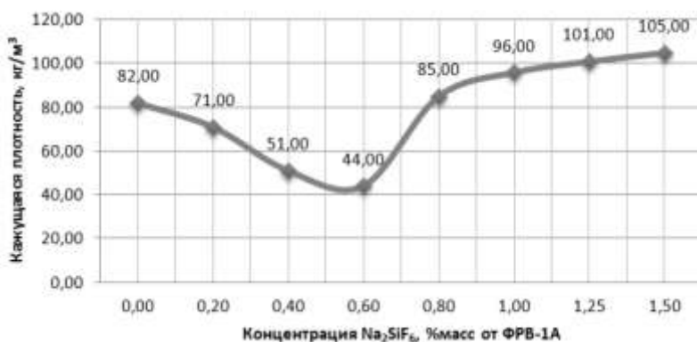
Рис.1. График зависимости плотности ФРП от концентрации \text{Na}_2\text{SiF}_6
