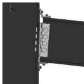
Рис. 2 Деформированная модель узла
