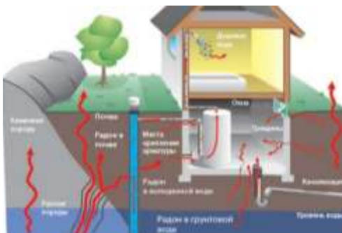
Рис. 1. Проникновение в здание радиоактивного газа- радона
