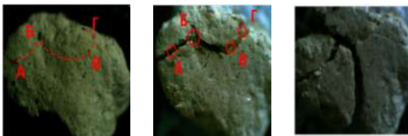
Рис. 1. Структура цеолита при увеличении \times 10 : а) контрольный цеолит; б) цеолит, обработанный в течение 1 мин.; в) цеолит, обработанный в течение 1,5 мин.
