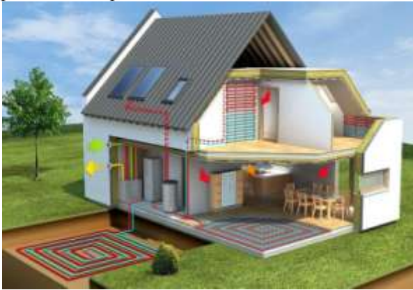
Рис. 3. Особенности пассивного дома
