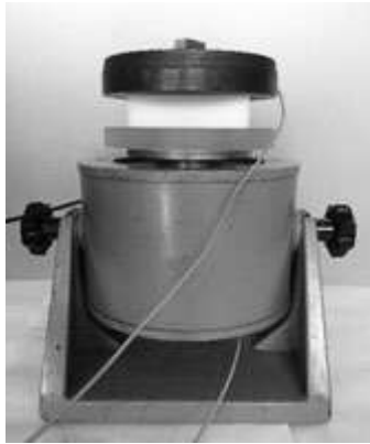
Рис. 1. Схема испытания материалов на виброизоляционном столе
