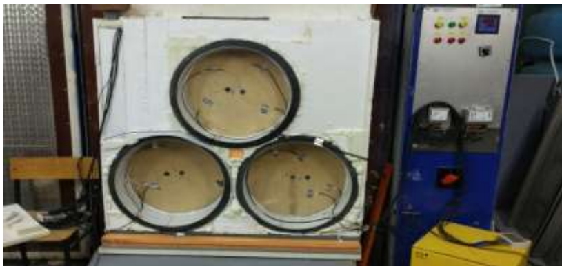
Рис.1. Проведение испытания на теплопроводность
