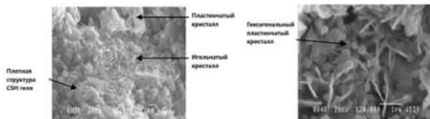
Рис. 1 Микроструктура коррозионностойкого бетона
