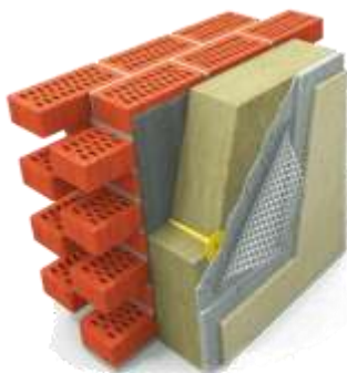
Рис. 2. Визуализация «мокрый фасад»
