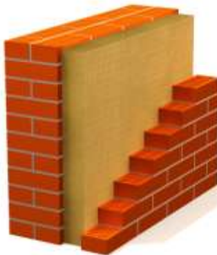
Рис. 1. Утепление стены внутри кладки
