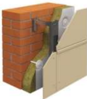
Рис. 3. Визуализация «вентилируемый фасад»
