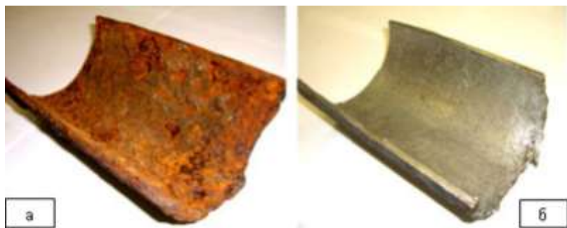
Рис. 2 Внешний вид трубы после трёхлетней эксплуатации в контакте с технической водой, не содержащей ингибитор (а) и содержащей ингибитор (б).
