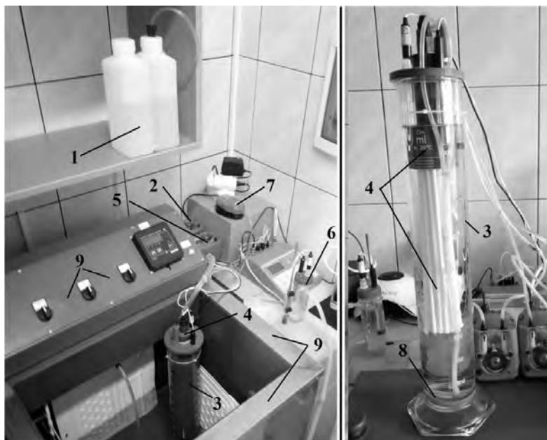
**Рис. 2.** Лабораторная установка реактора с ультрафильтрационным разделителем: 1 – расходная емкость с модельной водой; 2 – насос подачи модельной воды; 3 – реактор-окислитель; 4 – ультрафильтрационный разделитель; 5 – насос отвода пермеата; 6 – Eh-ячейка; 7 – компрессор подачи воздуха; 8 – аэратор; 9 – крио-термостат
