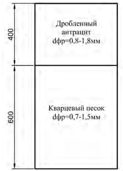
**Рис. 2.** Схема загрузки скорого напорного фильтра
