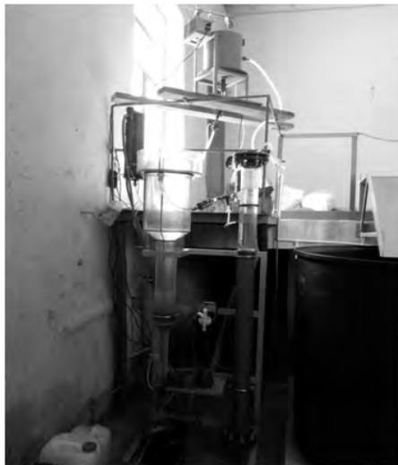
**Рис. 3.** Опытно-производственная пилотная установка дедорации воды
