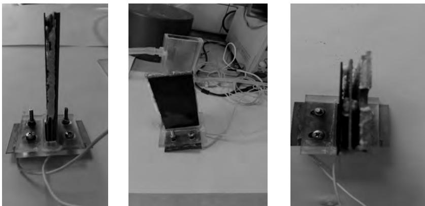
Рис. 6. Электроды, отработавшие 72 часа в декарбонизированном растворе
