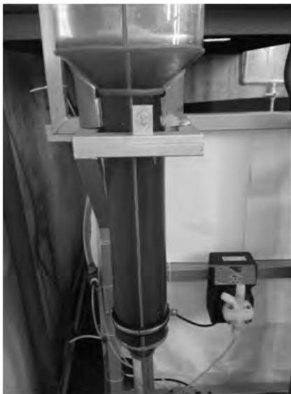
**Рис. 4.**Слой взвешенного осадка хлопьев  $Al(OH)_3$  с сорбированным на них ПАУ
