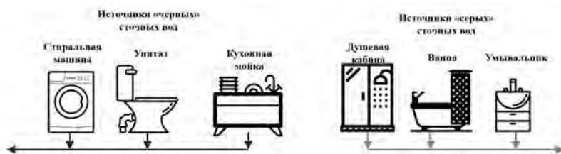
Рис. 2. Децентрализованное водоотведение в местах образования сточных вод
