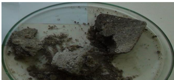
Рис. 1.1. Образцы бетона в опыте 2 (постоянная отрицательная температура), выдержанные в 2-х компонентной модели противогололедного реагента
