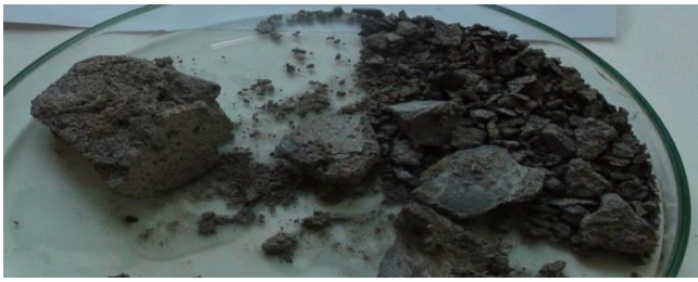
Рис. 1.3. Образцы бетона в опыте 3 (циклы, температурные перепады отрицательного значения температуры до положительного), выдержанные в 2-х компонентной модели противогололедного реагента.
