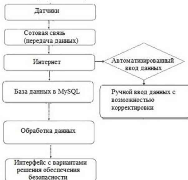
Рис. 1. Схема принципа работы автоматизированной системы мониторинга
