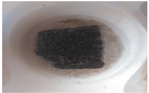
Рис. 1.10. Образцы бетона в опыте 20% растворе 3-х компонентной модели противогололедного реагента, при цтклических испытаниях (перепад температур с + на -, 25 циклов).
