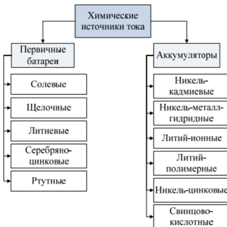
Рис. 1. Классификация отработавших химических источников тока.
