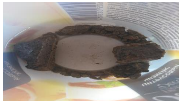
Рис. 1.6. Образцы бетона в опыте 4% растворе 3-х компонентной модели противогололедного реагента, при циклических испытаниях (перепад температур с + на -, 25 циклов).
