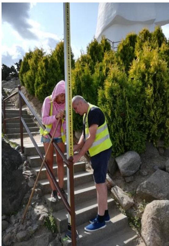
Рис.4. Процесс проведения высоко- точного нивелирования
