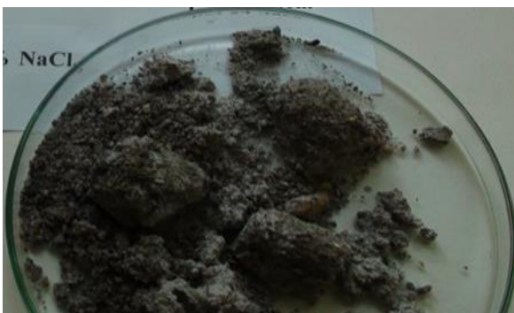
Рис. 1.5. Образцы бетона в опыте 2% растворе 3-х компонентной модели противогололедного реагента, при циклических испытаниях (перепад температур с + на -, 25 циклов).
