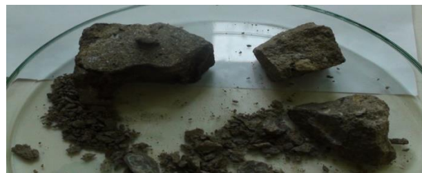
Рис. 1.2. Образцы бетона в опыте 2 (постоянная отрицательная температура), выдержанные в 3-х компонентной модели противогололедного реагента.
