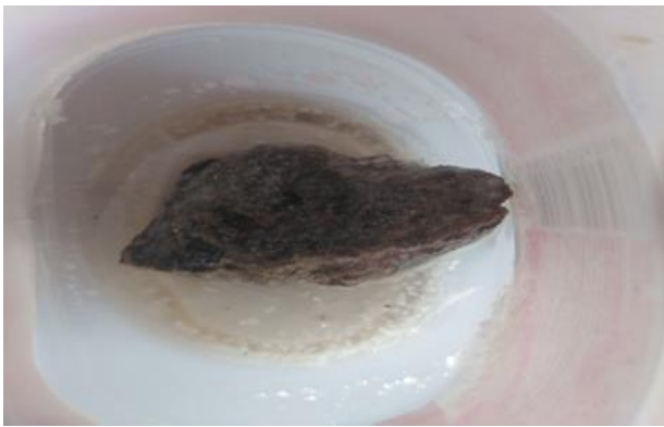
Рис. 1.9. Образцы бетона в опыте 16% растворе 3-х компонентной модели противогололедного реагента, при цтклических испытаниях (перепад температур с + на -, 25 циклов).
