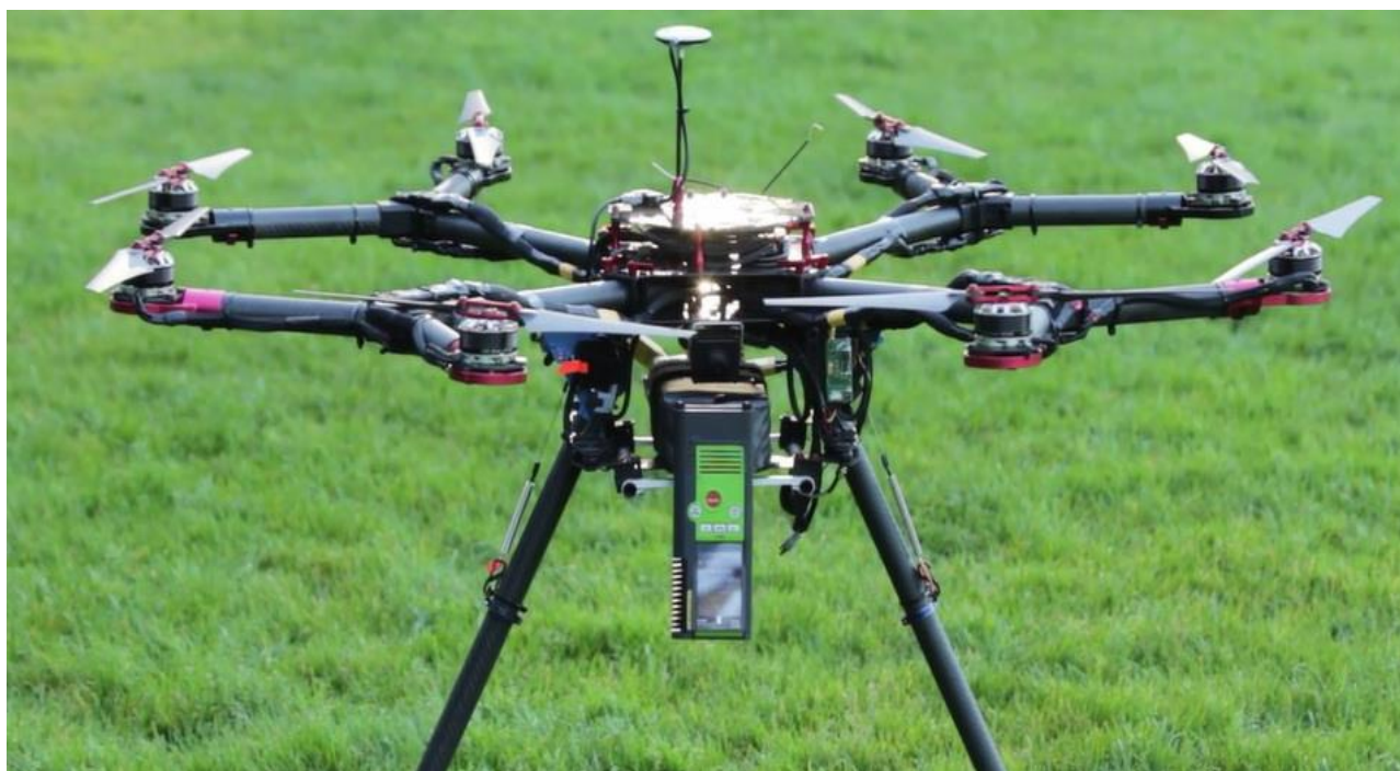
Рис. 2. Квадрокоптер оснащен газоанализатором.
