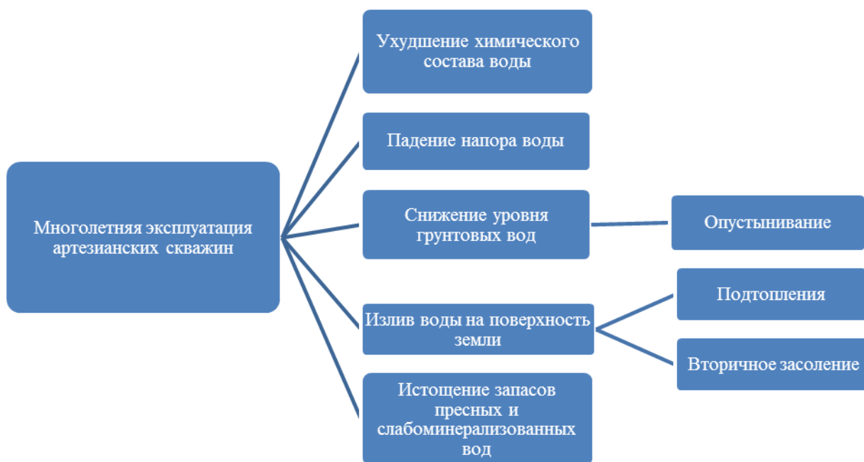
Рис. 3. Схема последствий бессистемной и длительной добычи подземных вод.
