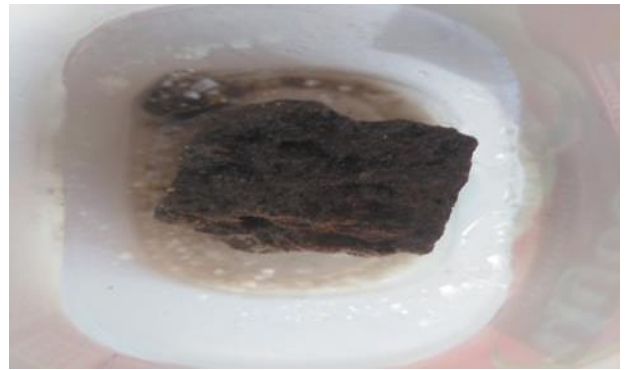
Рис. 1.8. Образцы бетона в опыте 12% растворе 3-х компонентной модели противогололедного реагента, при цтклических испытаниях (перепад температур с + на -, 25 циклов).
