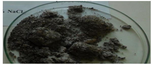
Рис. 1.4. Образцы бетона в опыте 3 (циклы, температурные перепады отрицательного значения температуры до положительного), выдержанные в 3-х компонентной модели противогололедного реагента.
