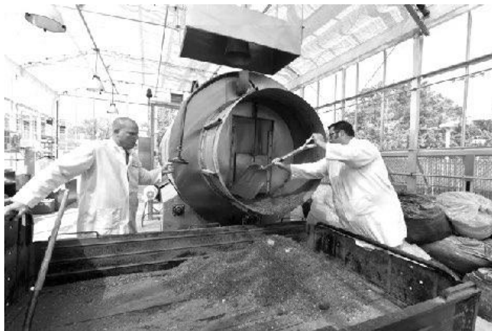
Рис. 2. Материал загружается постепенно в реактор, внутри которого осуществляется перемешивание материала и постоянная подача кислорода. При этом идет строгий контроль над уровнем влажности и кислорода.
