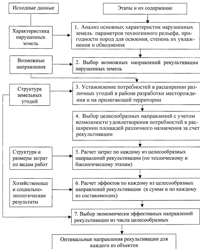
Рис. 1. Блок-схема укрупненного алгоритма поиска оптимального направления рекультивации
