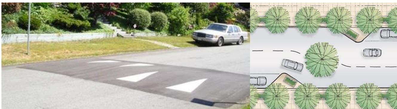
Рис. 1 Планировочные приемы (Traffic Calming) для снижения скорости трафика.
