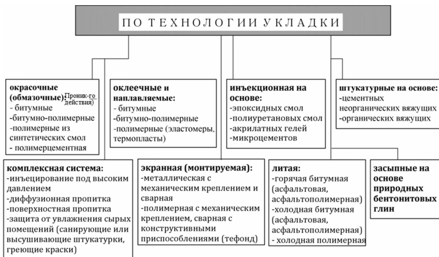
Рис. 2. Классификация гидроизоляционных материалов по технологии укладки
