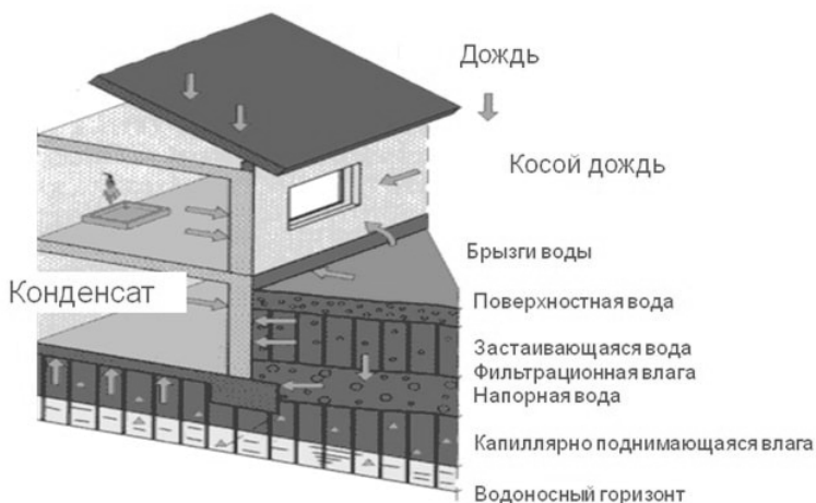
Рис. 1. Схема воздействия воды на конструкции здания
