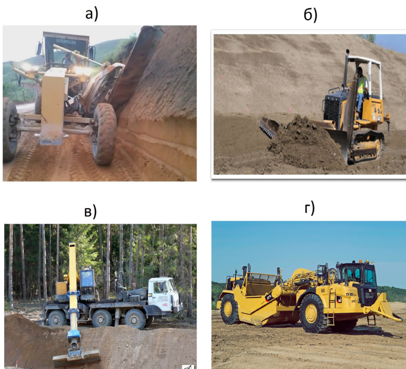
Рис. 1. Машины для земляных работ, которые могут применяться при планировке откосов:
