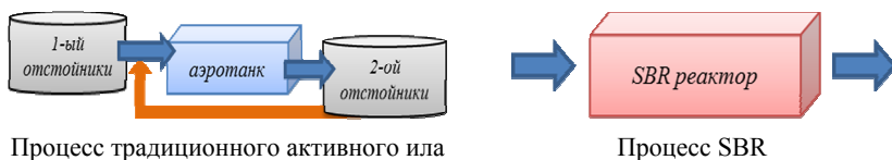
Рис. 1. Сравнение процессы традиционного активного ила и SBR
