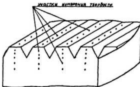
Рис. 3. Схема измерения микротвёрдости на контактных площадках поверхности.
