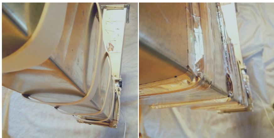
Рис. 3. Фото экспериментальной установки. Слева: прокладка гибкого ленточного нагревательного элемента, справа: фиксация кабеля с помощью самоклеющейся армированной ленты.
