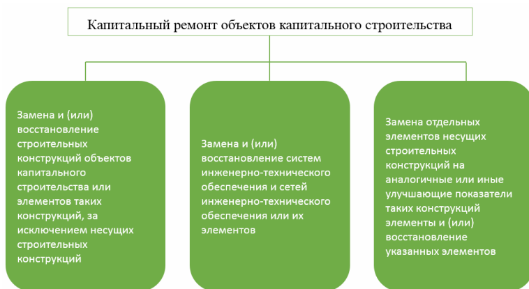
Рис. 1 Составляющие капитального ремонта зданий
