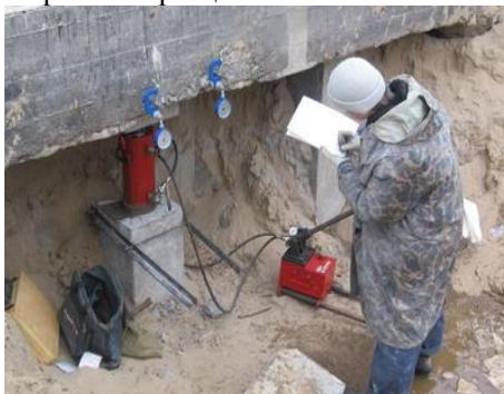
Рис. 2. Испытание сваи в свайном поле
