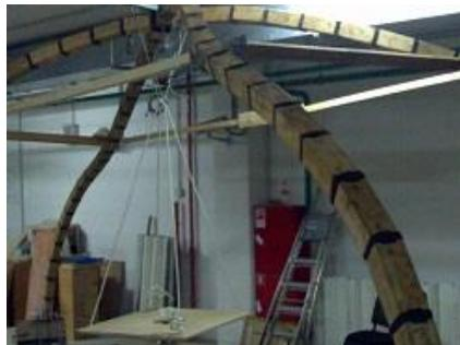
Рис. 3. Экспериментальный бионический модуль с нагружением конька сосредоточенной силой
