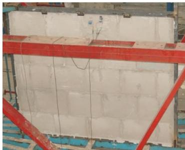
Рис. 1. Общий вид виброплатформы с установленным эталонным образцом панели.
