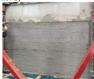
Рис. 2. Общий вид панели, усиленной композитной сеткой
