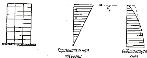
Рис. 4. Распределение горизонтальной нагрузки
