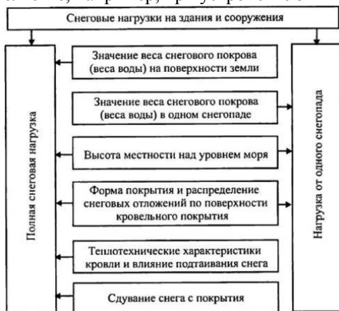
Рис. 1. Факторы, влияющие на формирование снеговых нагрузок на покрытиях зданий
