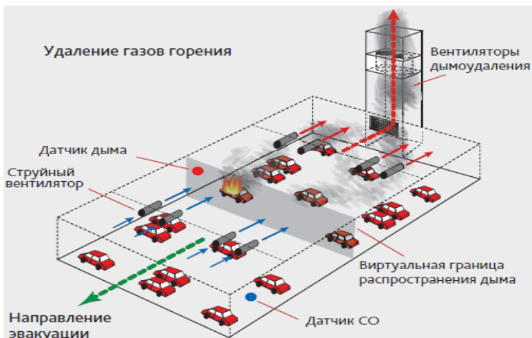
Рис.3. Продольная схема дымоудаления при пожаре на автостоянке.
