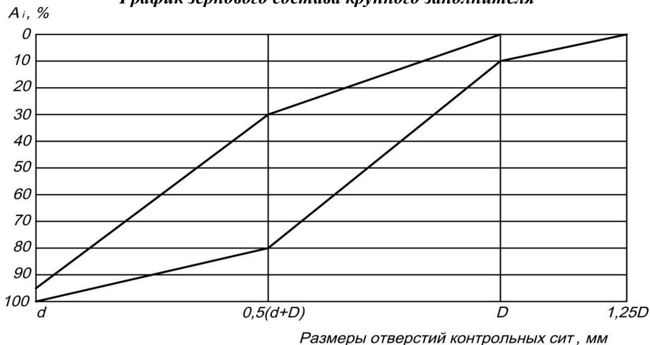
Таблица 20. Зерновой состав смеси фракций крупного заполнителя 5...20 мм
