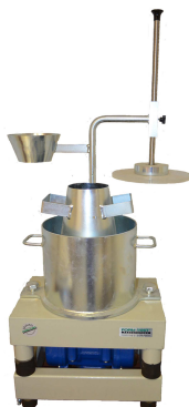
Технический вискозиметр (установка типа Вебе)
