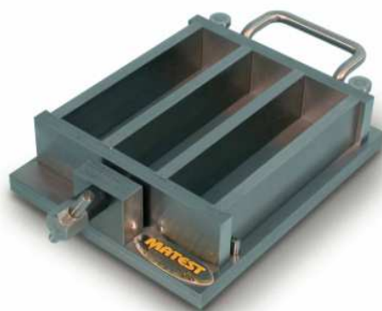
Трехгнездовая форма для изготовления образцов-балочек размером 4×4×16 см
