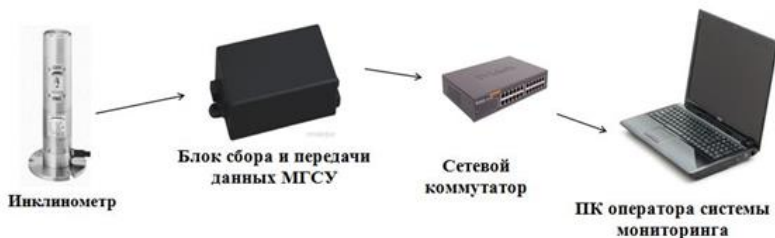
Рис. 1. Блок-схема простейшей системы мониторинга
