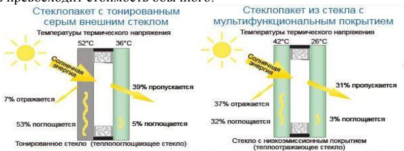
Рис. 3. Теплопоглощающие и теплоотражающие стекла
