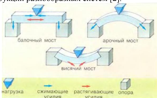
Рис. 1. Основные формы мостов
