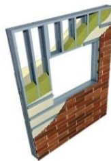
Рис. 5. Каркасные наружные стены
