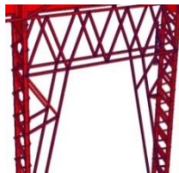
Рис. 6. Связи между колоннами
