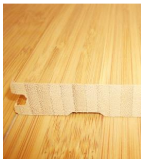
Рис. 2. Клеёная плита из бамбука
