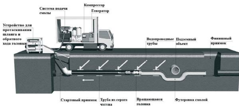
Рис. 2. Принципиальная схема реализации метода бестраншейной реновации трубопровода из серого чугуна
