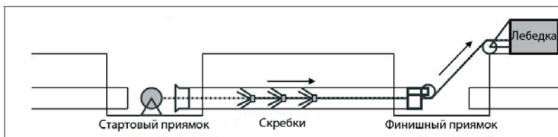
Рис. 3. Очистка внутренней поверхности трубы от загрязнений с помощью скребок
