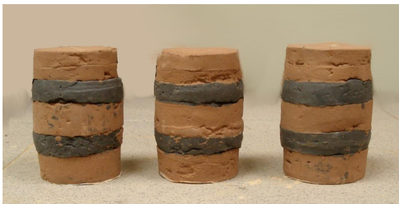
Рис. 2. Фото разрушенных анизотропных образцов
