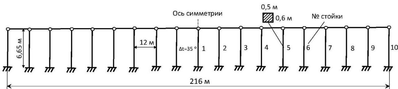
Рис.1. Расчетная схема рамы по примеру 8 из руководства [1]
