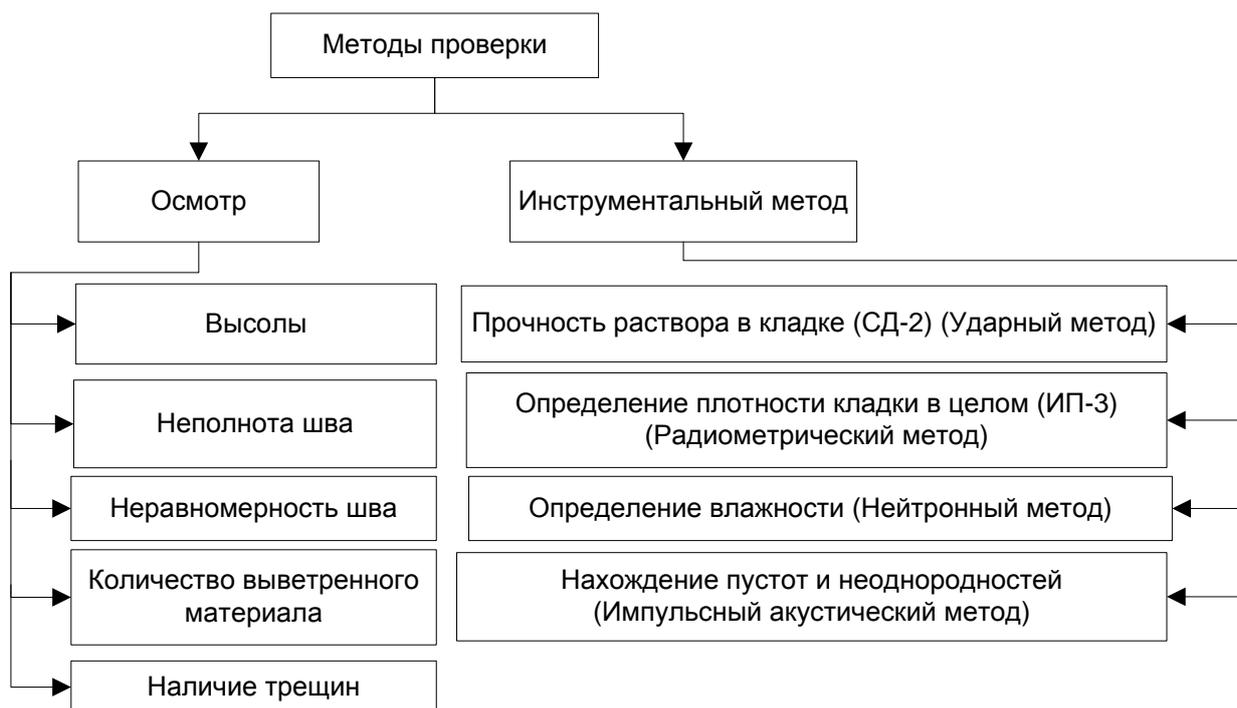
Рис. 3. Методы проверки кирпичной кладки
