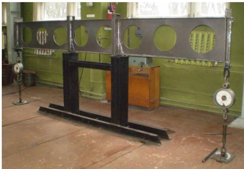
Рис. 2. Модель перфорированной балки с круглыми вырезами, изготовленная с помощью описываемой технологии
