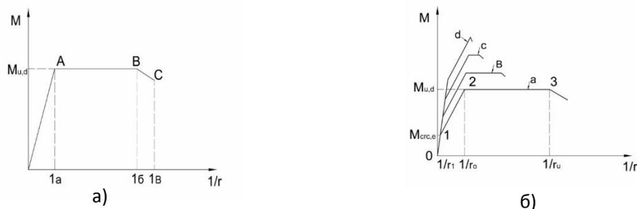
Рис. 1. а) Диаграмма момент-кривизна и предельные состояния, возникающие в элементе, б) Диаграммы деформаций внецентренно сжатых элементов, при различных эксцентриситетах:
