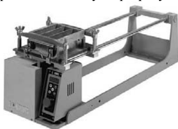
Рис. 7.24. Встряхивающий стол для уплотнения цементного раствора в формах по ГОСТ 30744–2001
