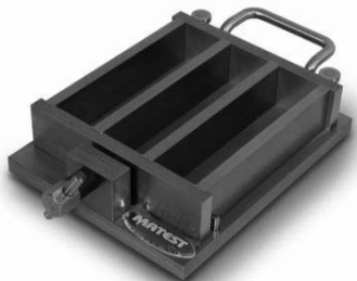
Рис.7.12. Трехгнездовая форма для изготовления образцов-балочек размером 4×4×16 см
