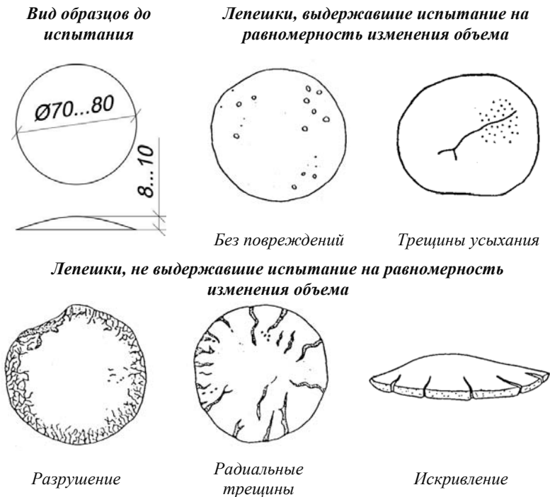
Рис. 7.9. Внешний вид образцов до и после испытания на равномерность изменения объема по ГОСТ 310.3–76
