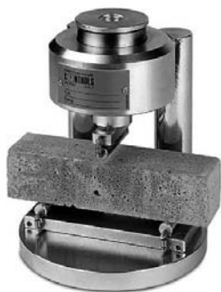
Рис. 7.16. Устройство для испытания образцов-балочек на изгиб
