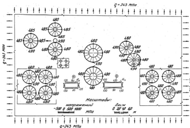
Эпюры контурных напряжений вокруг отверстий – проходок (без подкрепления). Эпюры  $\sigma_y$  в накладках отверстий
