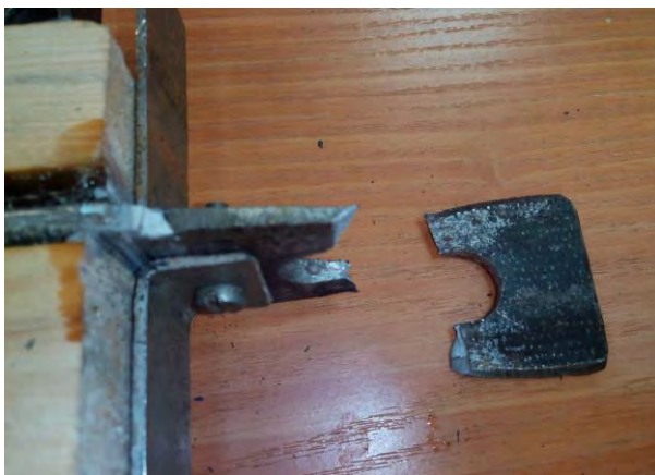
Рис. 4. Характер разрушения (а) и диаграмма испытания (б) образца с эксцентриситетом
