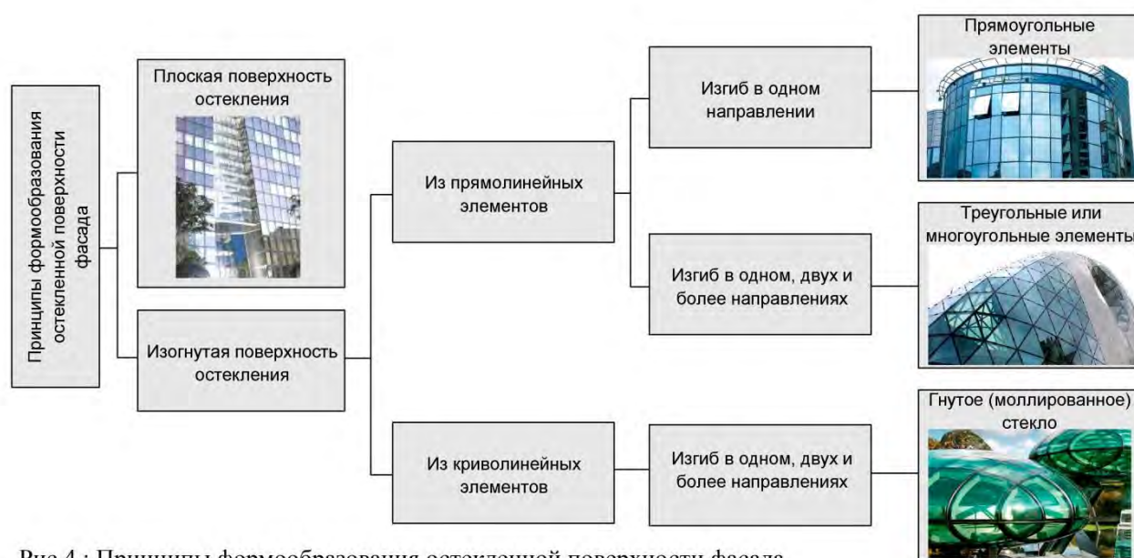
Рис.4.: Принципы формообразования остекленной поверхности фасада
