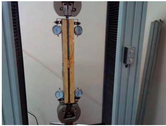
Рис. 3. Общий вид образца в захватах испытательной машины ИР 5082-100
