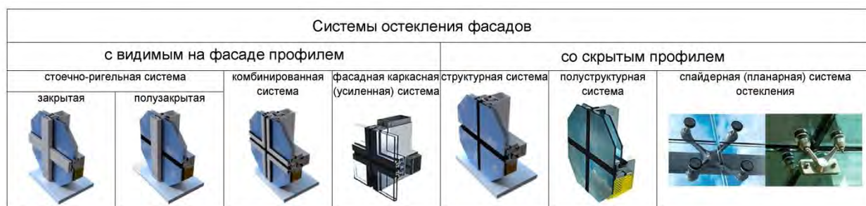
Рис.1: Системы остекления фасадов
