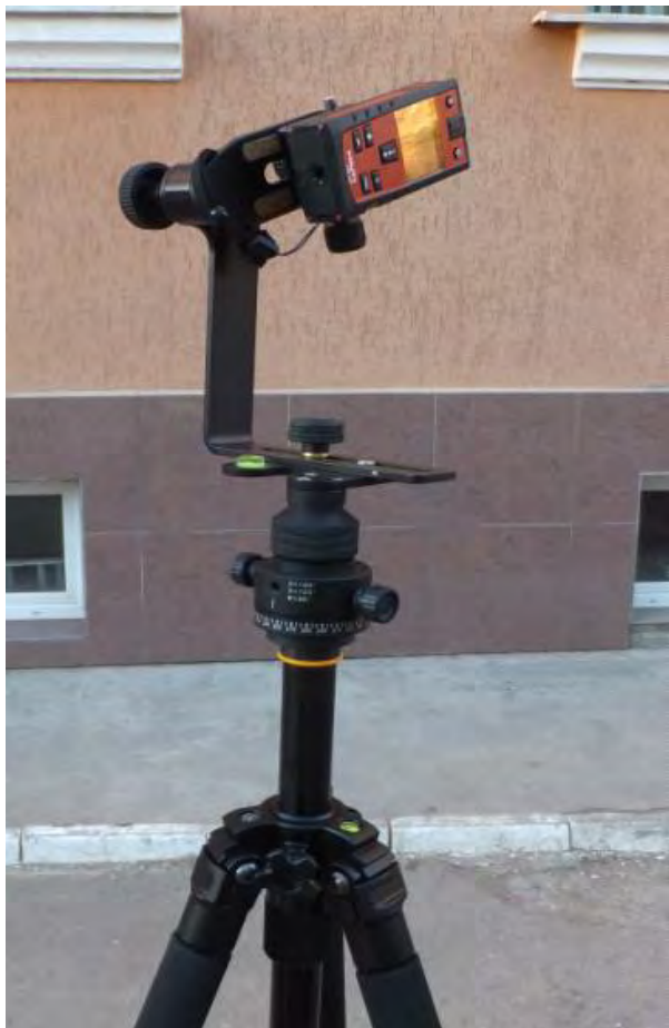
Рис. 1. Средство фиксации для определения геометрической модели обследуемой криволинейной поверхности
