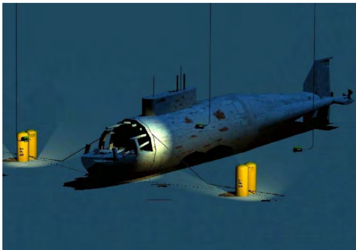
Рис. 2. Использование всасывающихся свай при подъеме АПЛ Курск
