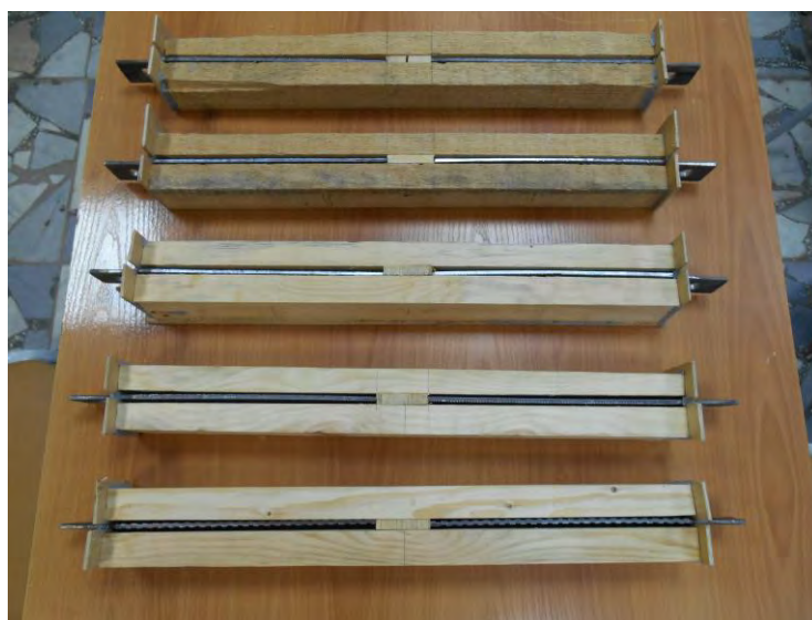
Рис. 1. Образцы, подготовленные к установке вставок, контролирующих толщину клеевого соединения, и заполнению пазов клеем
