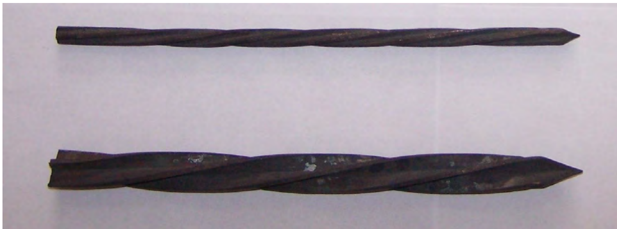
Рис. 1. Стальные стержни (нагели) крестообразного поперечного сечения с винтовыми ребрами
