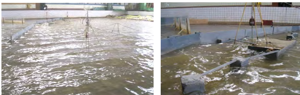
Рис. 4. Моделирование волновых процессов в акватории порта Сабетта
