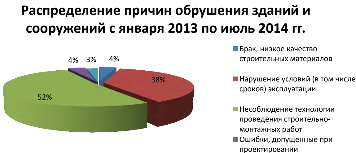
Рис.1. Диаграмма распределения причин обрушения зданий и сооружений в монолитном строительстве
