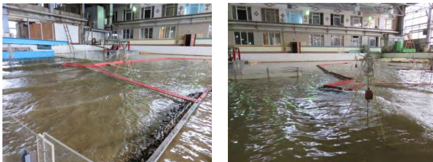
Рис. 5. Физическое моделирование сооружений портового терминала в бухте Восток
