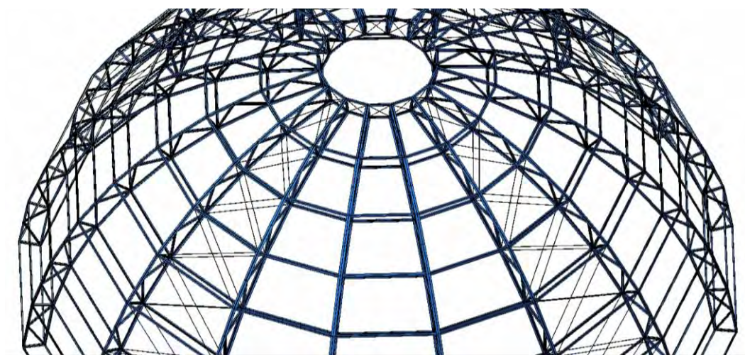
Рис. 1. Запроектированный каркас исследуемого ребристо-кольцевого купола
