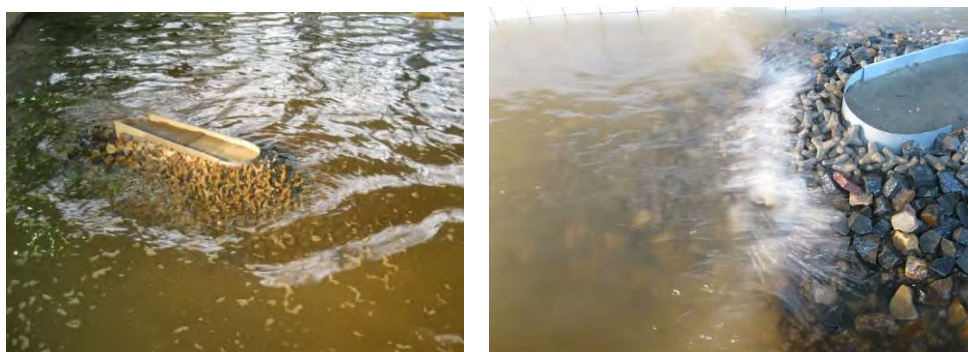
Рис. 3. Моделирование набросного откосного покрытия голов молов порта Тамань
