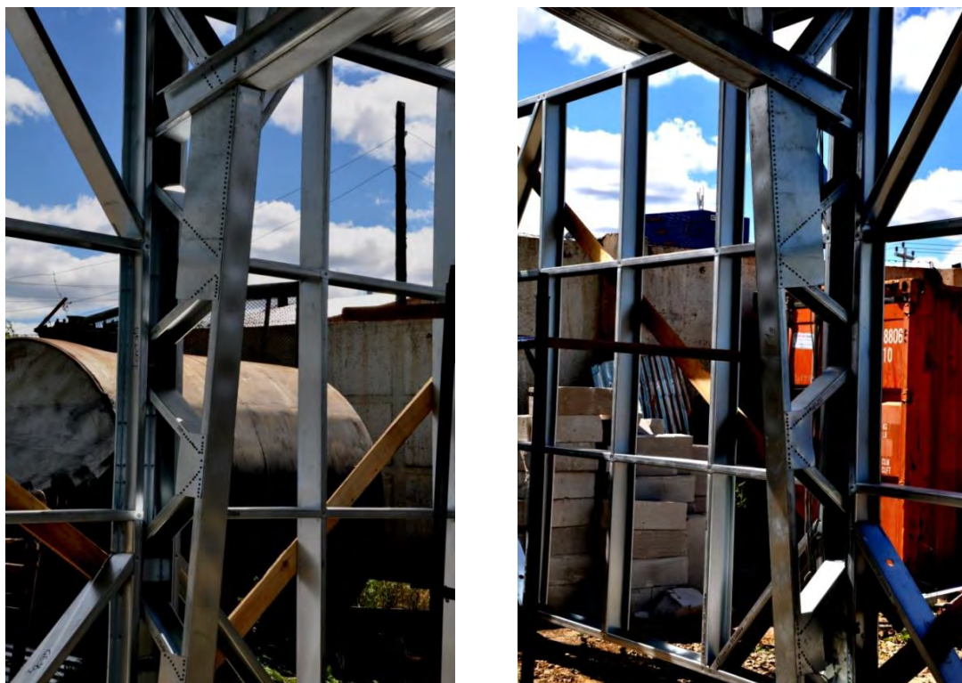
Фото 1. Потеря местной устойчивости внутренних ветвей стоек сквозной рамы после 1-го этапа нагружения
