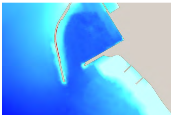
Рис. 2а. Распространение пятна дизельного топлива через 20мин после начала разлива при скорости ветра 15м/с в старой конфигурации порта
