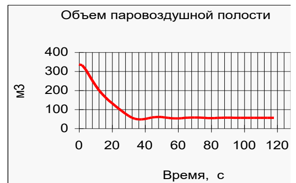
Рисунок 3.6. – Пуск насоса на частично заполненный подводящий водовод (а) и полностью заполненный подводящий водовод (б). Процесс в водоводах и конденсаторе
